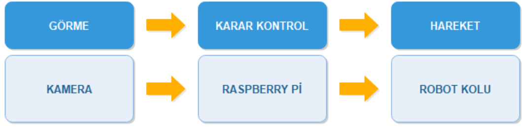
Şekil 0.43. Sistemin genel yapısı
