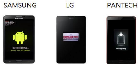
Fig. 1. Firmware update mode (Samsung, LG, and Pantech).
