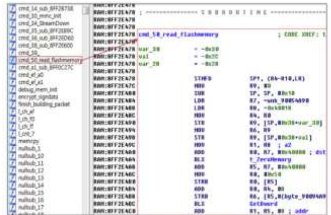
Şekil 3 - LG SBL3 ön yükleyicisinin tersine mühendislik yapılması
