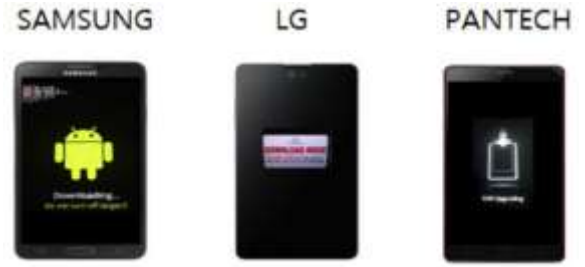
Şekil 1 - Firmware güncelleme modları (Samsung, LG, Pantech)
