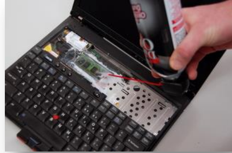
Şekil 24 - RAM sıvı nitrojen ile soğutulması
